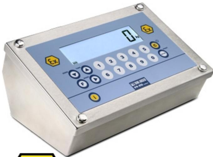
Visor de peso para zonas clasificadas con riesgo de explosión con modos de protección según ATEX II 3D Ex tc IIIC T130°C Dc IP65 X. Apto para sistemas de pesaje, dosificación y automatización. Homologable CE-M OIML R-76 / EN 45501.
