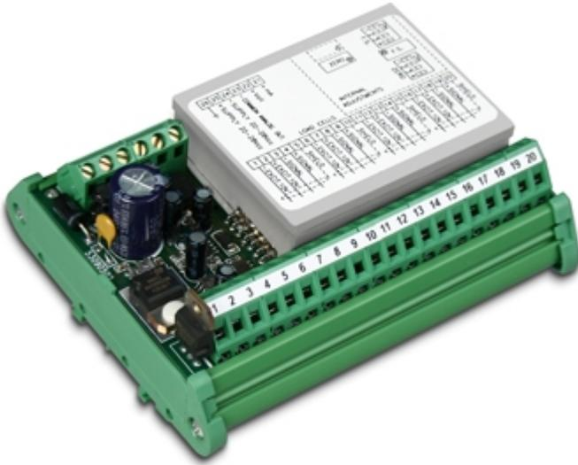
Transmisor de peso con salida analógica a selección 0-20mA, 4-20mA, 0-10 Vdc o +/- 5Vdc. Apto para montaje detrás del cuadro eléctrico o en cajón hermético sobre carril omega. Normalmente utilizado con tarjeta analógica/digital 12 bit instaladas al PLC.
