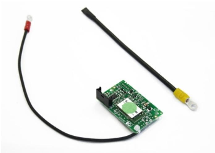
Interfaz que permite la conversión de un señal RS232 en radiofrecuencia 868MHz. Hasta 50 canales de transmisión, configurables mediante programa por PC. Gracias a los consumos reducidos y a la gran distancia de transmisión, es ideal para la realización de sistemas móviles o transmisión radio wireless.
