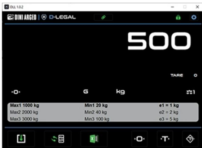
DLEGAL es un instrumento de pesaje digital homologado, es decir, un software mediante el cual el PC se convierte en el visor de peso primario del sistema de pesaje (NAWI).
