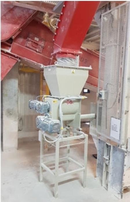
Los alimentadores por pérdida de peso controlan el peso a medida que pasa el tiempo y calculan el flujo de material. Se utiliza un lazo de control PID para regular el flujo de material según se dispensa. El producto se puede transportar mediante un transportador de tornillo, transportador vibratorio, transportador de cinta u otros. Rice Lake puede suministrar solo la báscula o el sistema completo con el transportador dosificador.
