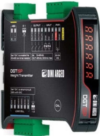
Transmisor de peso multifunción compacto, para montaje en panel sobre barra DIN. Permite la lectura directa y el diagnóstico del sistema de pesaje conectado. La amplia gama de interfaces disponibles hace que la integración del pesaje en cualquier sistema de automatización sea más fácil y segura.
