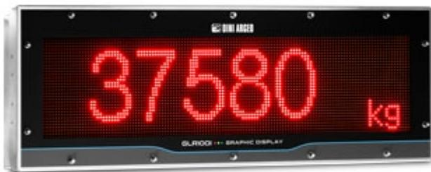
Repetidor gráfico alfanumérico con matriz de LEDES SUPERLUMINOSOS RGB, ideal para la visualización del peso y de mensajes operativos. En función del visor conectado, es posible visualizar el peso en cifras grandes o bien, mensajes operativos personalizables. La tecnología RGB permite cambiar el color de la visualización con la función semafórica (rojo, amarillo, verde). Caja de acero inoxidable y grado de protección IP68.
