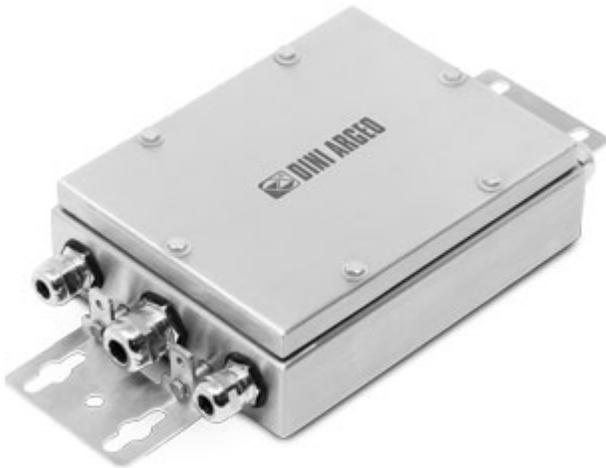
Caja suma de acero inoxidable AISI 304 con grado de protección IP68/IP69K contra el agua y el polvo, equipada con una tarjeta electrónica para la unión e igualación de 4 células. Trimmer de ajuste de la señal, para una ecualización precisa y fiable. El soporte de fijación reversible permite colgar la caja de conexiones en la pared, ahorrando espacio.
