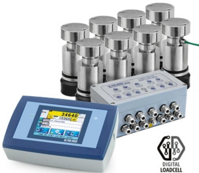
Kit para la realización de básculas puente digitales, compuesto por visor de peso con pantalla táctil 3590ETD con programa AF03 específico para básculas puente, 8 células de carga digitales de la serie DINI ARGEO "RCPTD", IP68, con articulaciones oscilantes de acero galvanizado y caja de ecualización digital, con descargadores de sobretensión.
