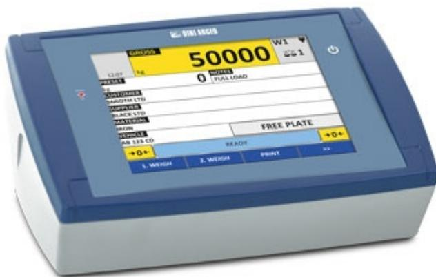
Visor de peso digital con gran pantalla táctil de 8", apto para aplicaciones industriales avanzadas. Permite de visualizar todos los datos de las pesadas y de personalizar las pantallas, lo que simplifica enormemente las operaciones del usuario. Equipado de 3 puertos seriales, puerto Ethernet, protocolos de transmisión datos, impresiones totalmente configurables, memoria alibi integrada y entrada por lector de códigos de barras/etiqueta de identificación. Homologables CE-M (OIML R-76/EN45501).
