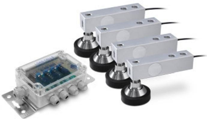
Aptos para realizar plataformas de 4 células de carga de dimensiones y capacidad varias. El equipo consta de 4 células de carga de 350 Ohm, homologadas OIML y NTEP, de acero niquelado IP67, completas de pies de apoyo regulables y una caja de ecualización.
