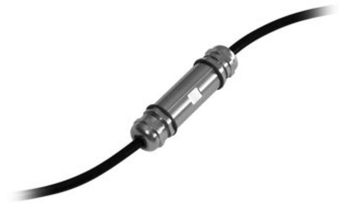
Caja suma de acero inoxidable con grado de protección IP68 contra agua y polvo, provista de tarjeta electrónica para la unión de 2 secciones de cables de células de carga. Los 8 bloques de bornes de tornillos facilitan la conexión de los cables. El cuerpo de acero inoxidable asegura robustez y durabilidad.
