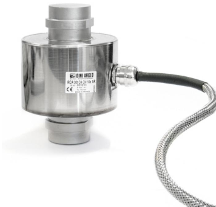
Células de carga analógicas a compresión para básculas puente homologadas CE-M, depósitos, silos, etc. Totalmente en acero inoxidable, con grado de protección IP68, 4000 divisiones, cable armado "contra rata" de serie.
