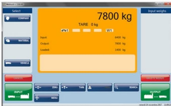
Programa para PC que permite la gestión completa de un sistema de báscula de puente, que se puede juntar a visores de peso serie DFW, DGT y 3590. Además a la gestión completa de la báscula conectada, el programa ofrece una interfaz operador simple e intuitiva, archivos para la memorización de los datos de clientes, materiales y vehículos, gestión de los totales e impresiones programables.
