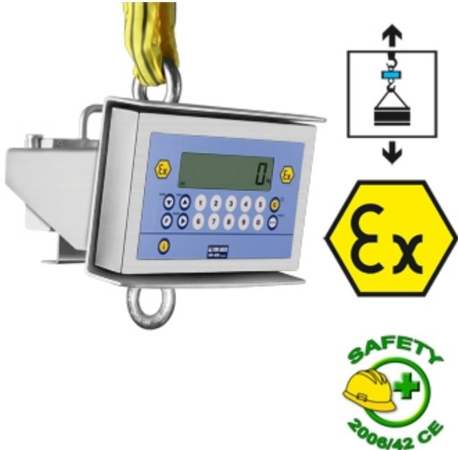
Ganchos pesadores para aplicaciones de pesaje en zonas clasificadas con riesgo de explosión (Zonas 1 y 21, 2 y 22) con modo de protección según ATEX Ex II 2G IIC T4 Gb X y Ex II 2D IIC T197°C Db X. Estructura totalmente de acero inoxidable, con grado de protección IP65. Gracias al sistema de seguridad simple son idóneos para levantar y pesar la carga. Su tamaño vertical reducido permite de ocupar muy poco espacio. Aptos para montaje de eslabón de unión superior y gancho inferior (opcionales).
