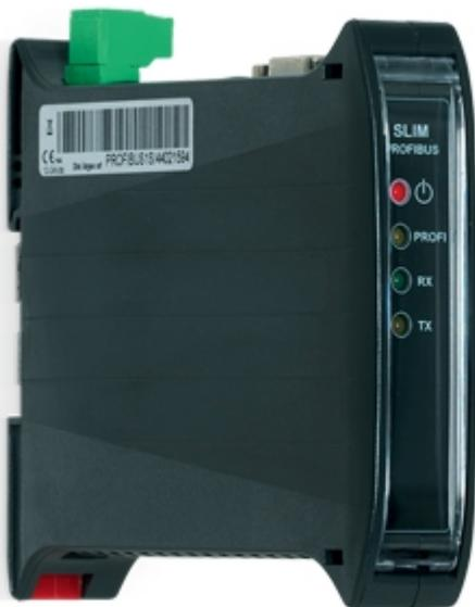
La interfaz PROFIBUS con función de hub permite monitorizar una sola balanza, o hasta 16 balanzas al mismo tiempo.
