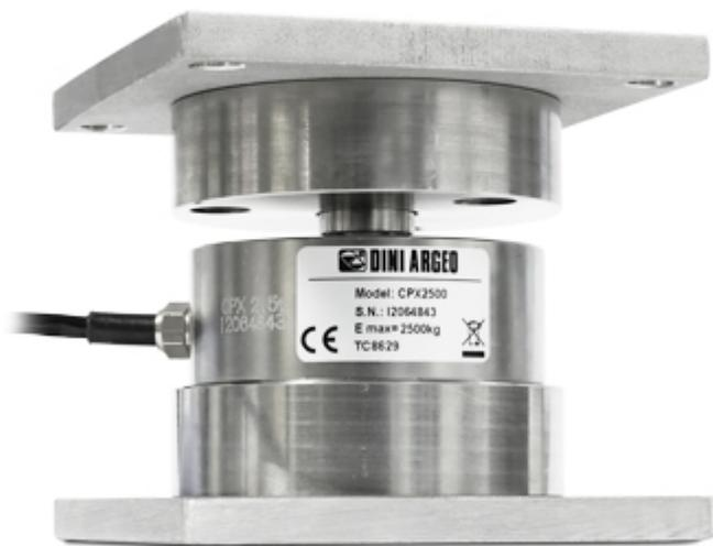
Gracias al kit componible ELGO, usted puede instalar rápidamente las células de carga a compresión serie CP/CPX hasta 12.500kg, para el pesaje de silos, tanques y varias estructuras, conteniendo los costes de instalación. Construido en acero INOXIDABLE y muy simple a limpiar, ELGO es ideal para pesar en ambientes hostiles o con elevados requisitos de higiene. Certificación ATEX II 2GD c IIC T6 85°C.
