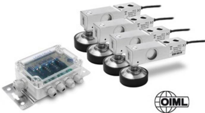
Aptos para realizar plataformas de 4 células de carga de dimensiones y capacidad varias. El equipo consta de 4 células de carga de 1000 Ohm, homologadas OIML, de acero inoxidable IP68, completas de pies de apoyo regulables de acero inoxidable y una caja de ecualización.
