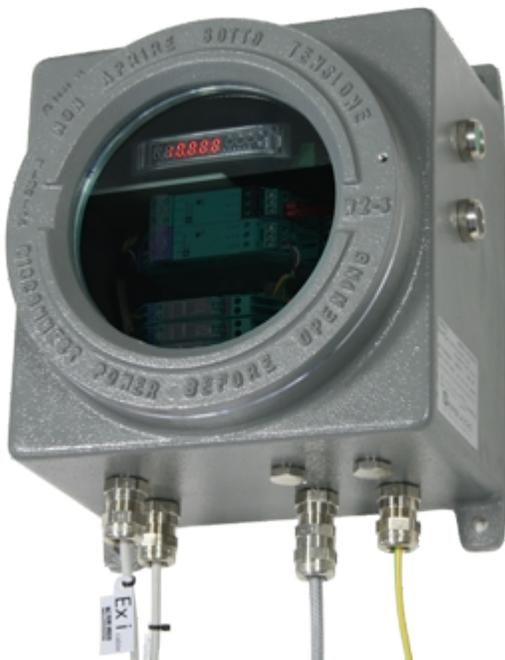
Box con protección Exd con visor/transmisor de peso, barreras Zener y salida analógica 4-20mA a seguridad intrínseca. Completo con 2 botones para las principales operaciones de pesaje con funciones configurables y dos salidas electrónicas programables para la gestión setpoint o niveles. Protección general: ATEX II 2 (1) GD Ex d [ia Ga] IIC T6 Gb / Ex tb [ia Da] IIIC T85°C Db IP66.
