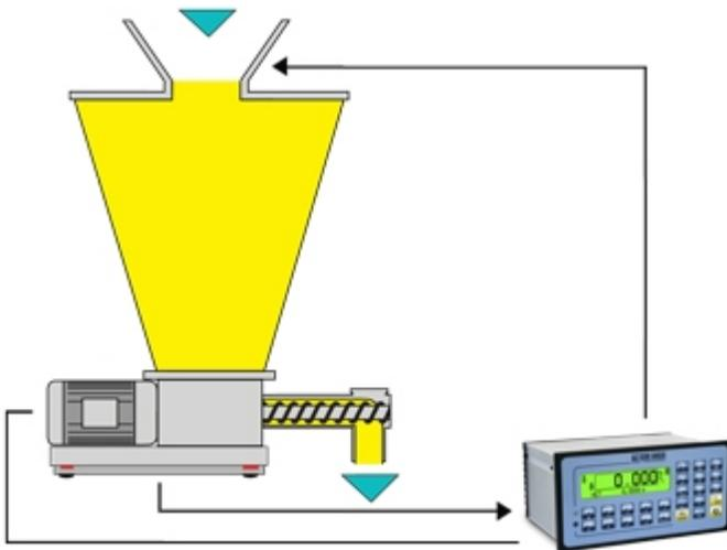
Versión software para la medición/integración del peso, de la capacidad de material en salida de silos, cisternas o tolvas, con memorización de la cantidad de material dosificado; posibilidad de regulación de la capacidad mediante salida analógica 16 bit y control PID. Posibilidad de gestión del instrumento desde remoto, mediante protocolos Sysway o Modbus RTU, o Profibus mediante interfaz opcional.
