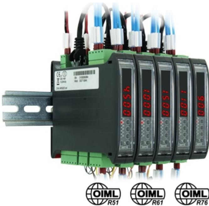
Transmisor / Visor de peso multifunción compacto, para montaje sobre carril DIN. Permite la lectura directa y diagnóstico del sistema de pesaje conectado. La amplia gama de interfaces disponibles, hace más fácil y segura la integración de las pesadas en cualquier sistema de automatización.
