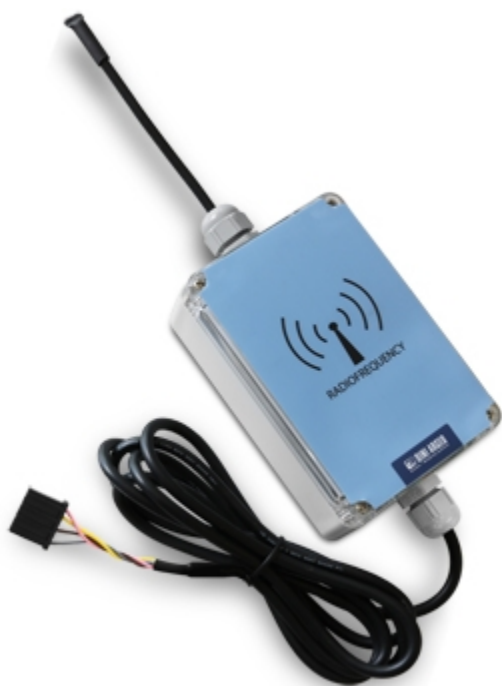
OBRF: módulo radio 868 MHz con entrada RS232.
