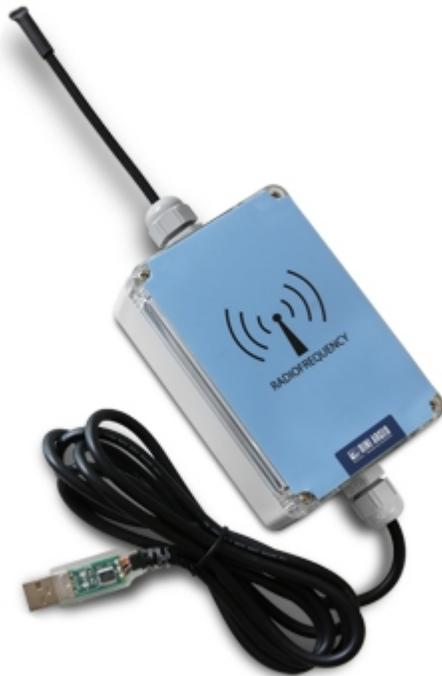
Box interfaz radiofrecuencia 868MHz, para la comunicación sin hilos entre PC/dispositivo master y visor/repetidor de peso. Hasta 50 canales de transmisión, configurables mediante programa sobre el ordenador. Conexión por entrada USB o RS232 (según el modelo).
