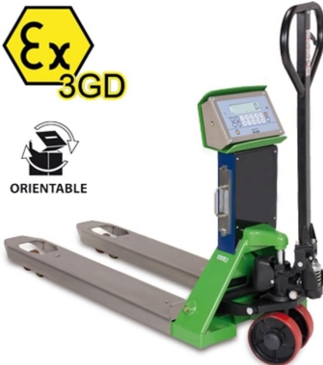
Transpaleta con pesaje electrónico integrado, apta para áreas peligrosas clasificadas como zonas con riesgo de explosión (ZONA 2 y 22) con modo de protección según Ex II 3G IIC T6 Gc X y Ex II 3D IIIC T115C° Dc X. La detección del peso por 4 células de carga inoxidable IP68, certificadas ATEX, garantiza precisión cualquier condición de trabajo. Fabricada, calibrada y ajustada en Italia por Dini Argeo, utilizando masas patrón certificadas. Disponible también en versiones HOMOLOGADAS CE-M.
