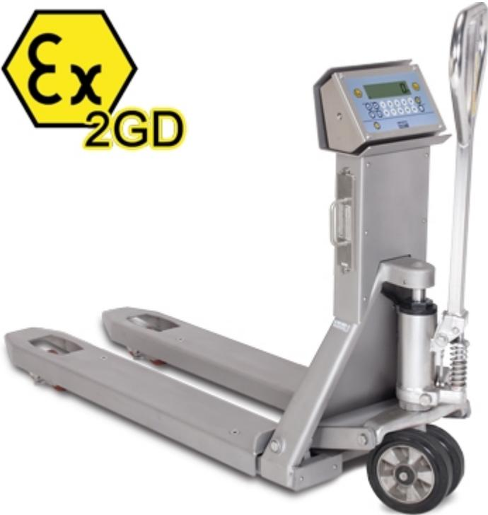
Transpaleta con pesaje electrónico integrado para áreas peligrosas clasificadas con riesgo de explosión (zonas 1 y 21 & 2 y 22) con grado de protección Ex II 2G IIB T4 T197°C X. La detección del peso por 4 células de carga de acero inoxidable IP68 con certificado Atex garantiza la máxima precisión, en cualquier entorno de trabajo. Estructura completamente de acero inoxidable. Disponible también en versión HOMOLOGADA CE-M.
